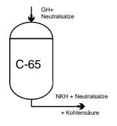
Die aus der KH freiwerdende Kohlensäure kann durch Lufteinblasen aus dem Fertigwasser ausgetrieben werden. Bei zu niedrigem PH kann mit Rohwasser verschnitten werden.
